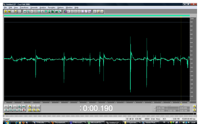
Figure 11. Rafale de décharges au sein d'un éclair d'orage relativement proche (domaine temporel)
