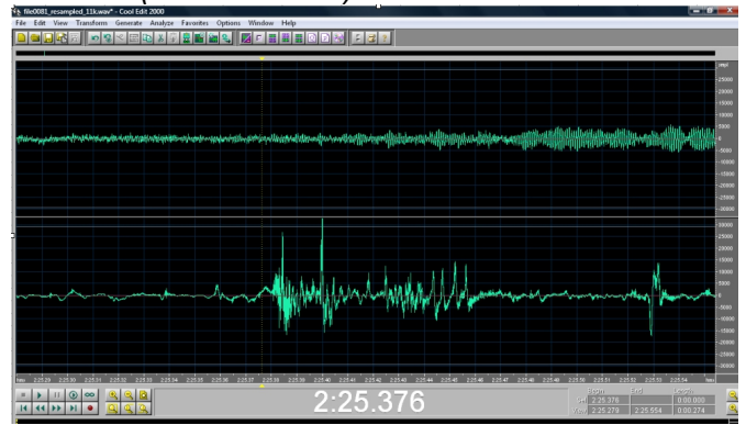
Figure 17. Rafale de pics VLF (canal du bas) survenant au début de la traînée turbulente d'un météore (canal du haut)
